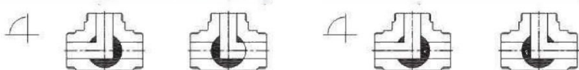
L型通口 L type gateway A向入口(A inlet) 90° 旋转方向(90 rotation direction)
